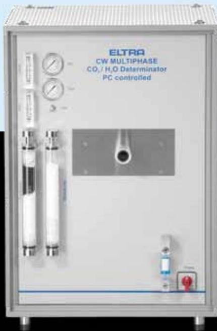
Анализатор Диоксида углерода / Воды CW-800M Multiphase
