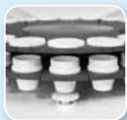
Размещение и снятие крышечек тиглей во время измерения
