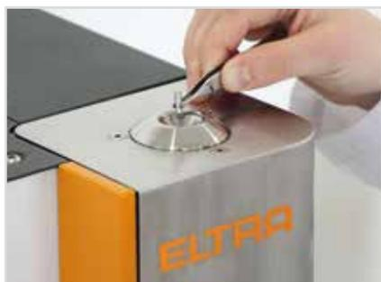
Загрузка пробы в порт сброса пробы
